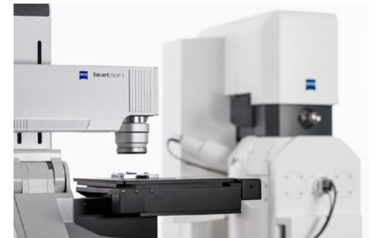
ZEISS EVO und das digitale Lichtmikroskop Smartzoom 5 in Kombination zur Vereinfachung korrelativer Workflows.
